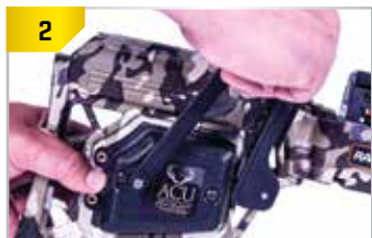
Soulagez la tension sur le dispositif ACUdraw avant de soulever la griffe hors de sa position de stockage (environ 1/4 de pouce à 1/2 pouce).
