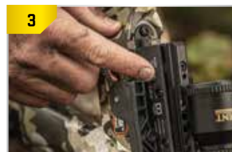
3 Appuyez sur le bouton De-Cock, puis insérez la poignée de manivelle et tournez 1 - 1/2 tours complets vers l'avant.
