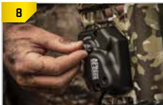
8 Tournez le collier de manivelle vers l'avant, doigt serré seulement.
