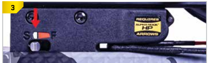
Lorsque vous armez votre arbalète correctement, la sécurité se déplacera automatiquement à la position SAFE (blanc), et le loquet de corde engagera la chaîne.
