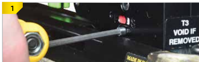
Retirez la vis du capuchon à tête hexagonale.
