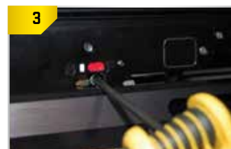
Réinsérez la vis de capuchon à tête hexagonale dans le bouton de sécurité.
