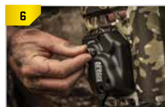
6 Utilisez vos doigts pour tourner le collier de manivelle dans le sens antihoraire (vers l'arrière) jusqu'à ce qu'il s'arrête.
