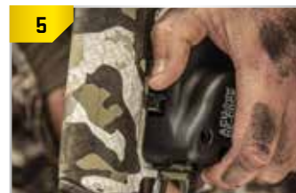
5 Appuyez et maintenez le bouton d'arrêt de vitesse pendant que vous retirez la poignée de manivelle.
