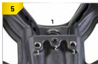
1. Boulon d'assemblage principal (et rondelles si nécessaire) 2. Ensembles de verrouillage du boulon d'assemblage principal 3. Pied Stirrup Verrouillage Setscrews
