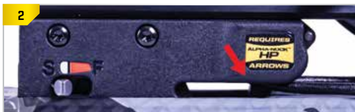
Si vous essayez d'armer l'arbalète alors que la sécurité est dans le COFFRE-FORT (blanc), position le DFI tiendra la corde d'arc et l'arc ne semblera être armé.
