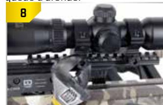
Déterminez la position de la portée et serrez les écrous de portée sur le support en queue d'aronde.
