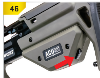
Hold the Gear Stop Button.
