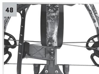
Insérez le carquois 3 flèches à dégagement instantané dans le support femelle et serrez-le en place avec le levier.
