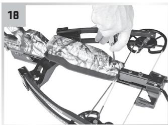
Retirez les vis du garde-main et des ailes de sécurité.
