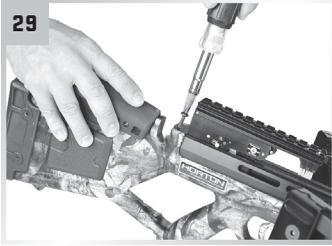
Insérez la vis autotaraudeuse.
