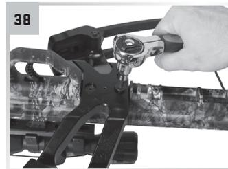
Insérez les vis de la rainure d'encastrement du canon.
