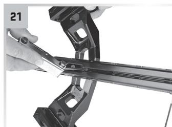
Retirez les vis de la rainure d'encastrement du canon.
