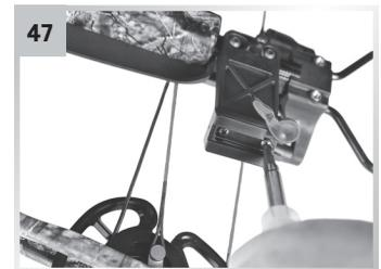
Installez le raccord femelle à démontage rapide.
