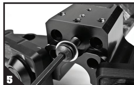
Installez le boulon et les rondelles d'assemblage principal.
