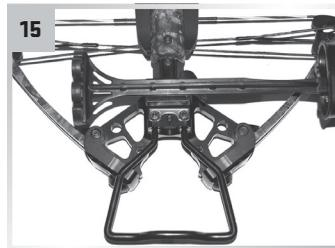
15 Insérez le carquois 3 flèches à dégagement rapide dans le support femelle et serrez-le en place avec le levier.
