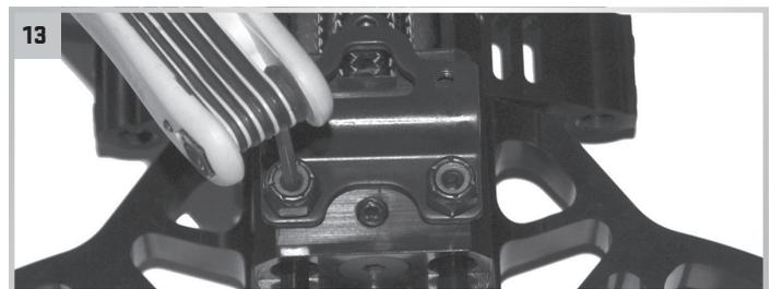
Insérez la vis de 3/4 po et les écrous à frein élastique (utilisez les vis de 1 po pour les arbalètes Wicked Ridge).
