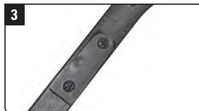
Fixez le raccord démontable mâle.
