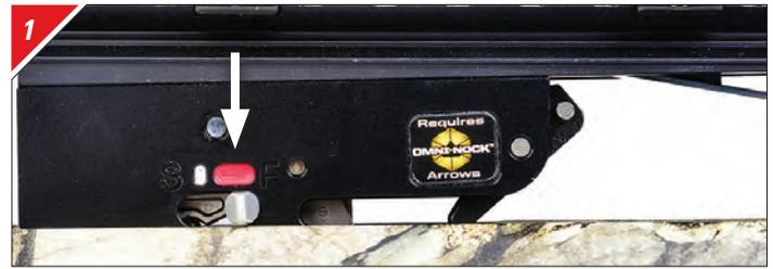
Assurez-vous que le mécanisme de sécurité de la détente est à la position avant FIRE, (vers l'avant, vers le point rouge) avant d'armer votre arbalète.
