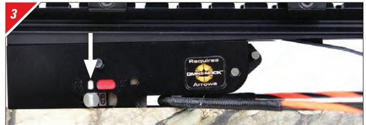
Lorsque vous armez votre arbalète correctement, le mécanisme de sécurité se déplace automatiquement à la position SAFE (vers l'arrière, vers le point blanc), et le câble est enclenché.
