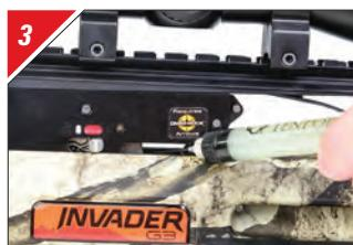
Appliquez une goutte à l'intérieur de l'extrémité fermée de la fente de détente.
