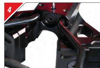
Desserrez la vis de réglage avant de tourner le boulon d'assemblage principal.
