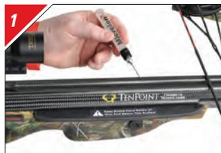
Lubrifiez le porte-flèche environ chaque 75 à 100 tirs avec un lubrifiant ou chaque 150 à 200 tirs avec le produit Microlon's® Precision Oiler.
