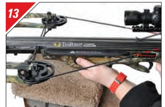
**BONNE POSITION.** Position correcte de la main pour un banc de tir pour une arbalète équipée avec GripSafety.
