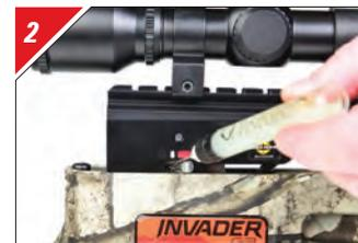
Lubrifiez la boîte de déclenchement par la fenêtre de sécurité.
