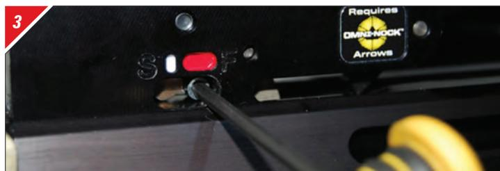
Réinsérez le capuchon vis à tête hexagonale dans le bouton de sécurité.
