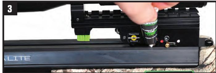
Appliquez une goutte à l'intérieur de l'extrémité fermée de la fente de la détente.
