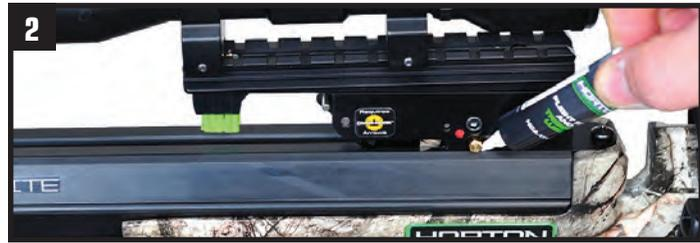
Lubrifiez la boîte de déclenchement par la fenêtre de sécurité.
