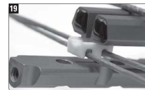
La rainure concave de la glissière devrait s'accoupler sous la fente inférieure de la rainure du vol de la flèche sous la rampe de lancement.
