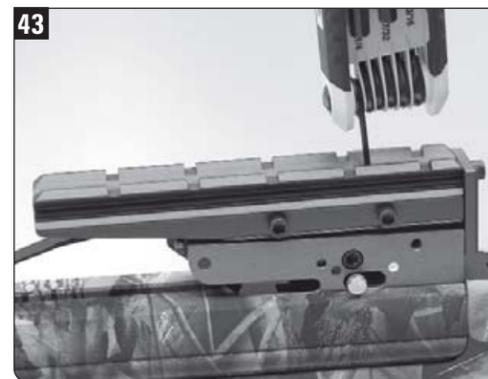
Accédez à la vis de tension par le dessus de la rainure sur le boîtier de la détente PowerTouch. Accédez à la vis de tension par le dessus du bloc de mire sur les boîtiers de détente RollerTouch et DropLatch.
