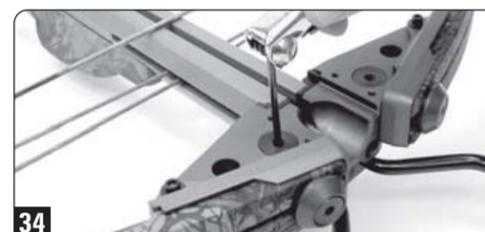
Desserrer les boulons de blocage avant de tourner les boulons des branches ou le boulon de montage principal (sur les arbalètes de la TenPoint Series).
