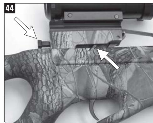
Les détentes RollerTouch et DropLatch possèdent un cran de sûreté ambidextre et un loquet de retenue de la corde de type « chute » ou « vers le bas ».
