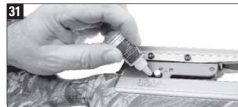
Lubrifiez la détente PowerTouch dans l'ouverture du cran de sûreté de la détente.
