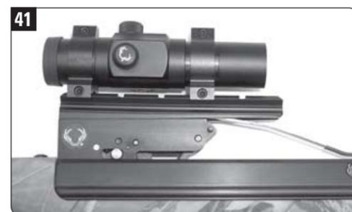
Monture de télescope fixe à rainure 7/8 pouce.
