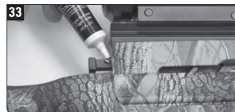
Lubrifiez l'arbre du cran de sûreté RollerTouch et DropLatch.
